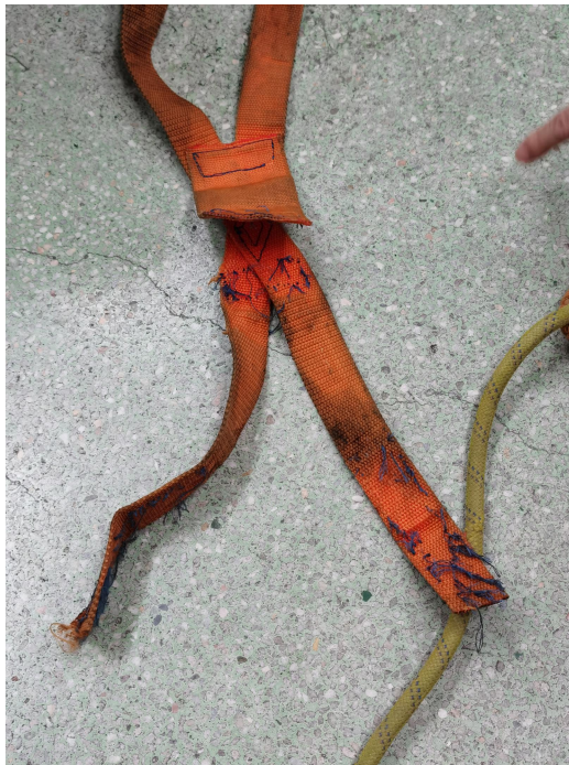
( 图 14 主带缝线爆裂散开 )
