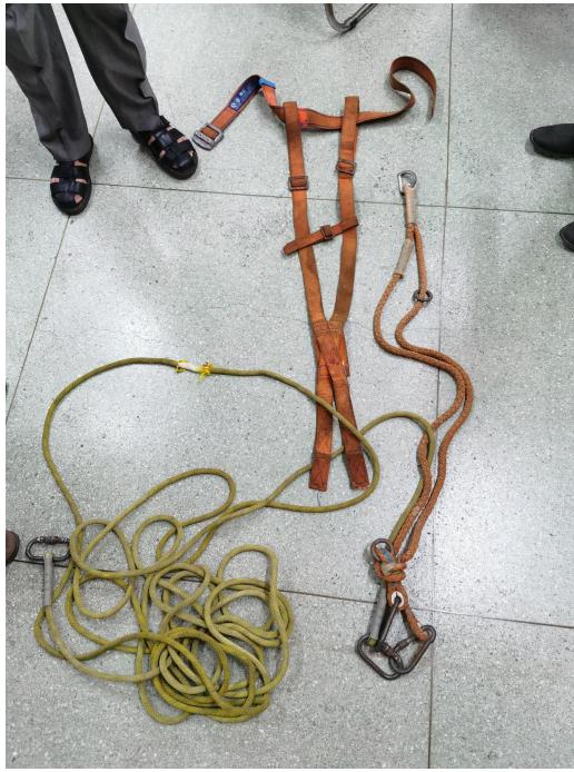
( 图 12 安全带断裂 )
