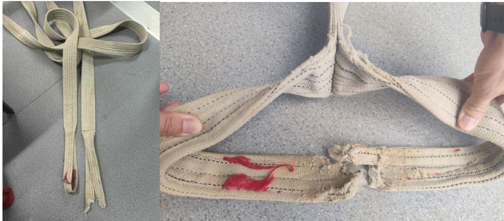
图 11、12 吊装带断裂环眼
