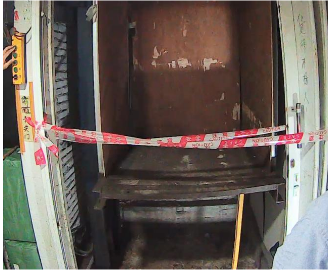
图 39 模拟载货平台坠落试验
